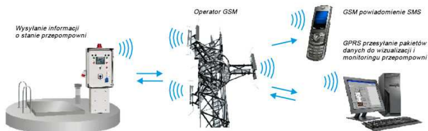
Schemat ogólny systemu monitorowania przepompowni
